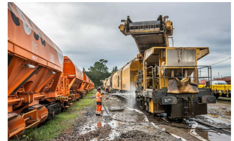
Entretien et nettoyage de la dégarnisseuse.
